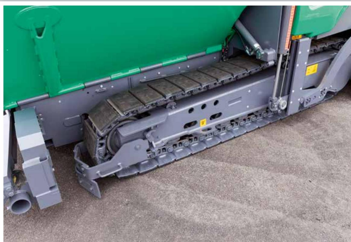
» **Les systèmes hydrauliques** de l'entraînement de translation, des systèmes de convoyement et de répartition du matériau ainsi que ceux des systèmes de compactage fonctionnent en circuits fermés indépendants et atteignent ainsi une efficacité optimale.
