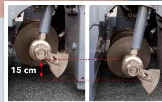
Les vis de répartition du SUPER 1600 sont réglables en hauteur par commande mécanique en continu jusqu'à 15 cm, ce qui permet ainsi de s'adapter à l'épaisseur de pose requise sur l'ensemble de la largeur de pose.
