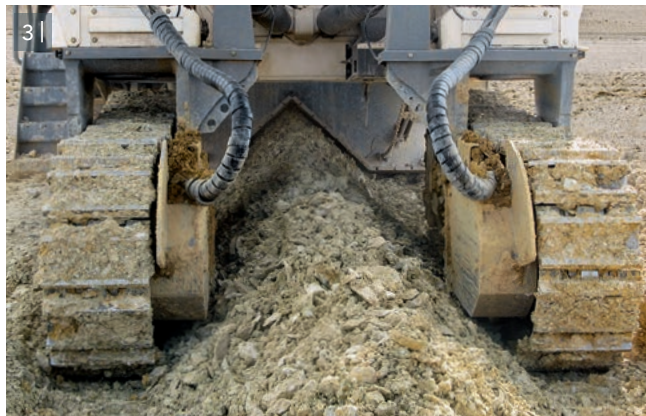
3 | Lors de la dépose du matériau en cordon sous la machine (procédé Windrow), les trains à chenilles avancent sur une surface plane grâce au reprofileur rabattable.
