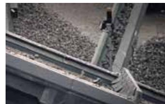
Les installations de criblages mobiles MOBISCREEN MS 952 et 953 EVO sont utilisées comme cribles de classification. Elles disposent d'un grand crible de 9,5 m<sup>2</sup> et répondent ainsi à des exigences de performance élevées.
