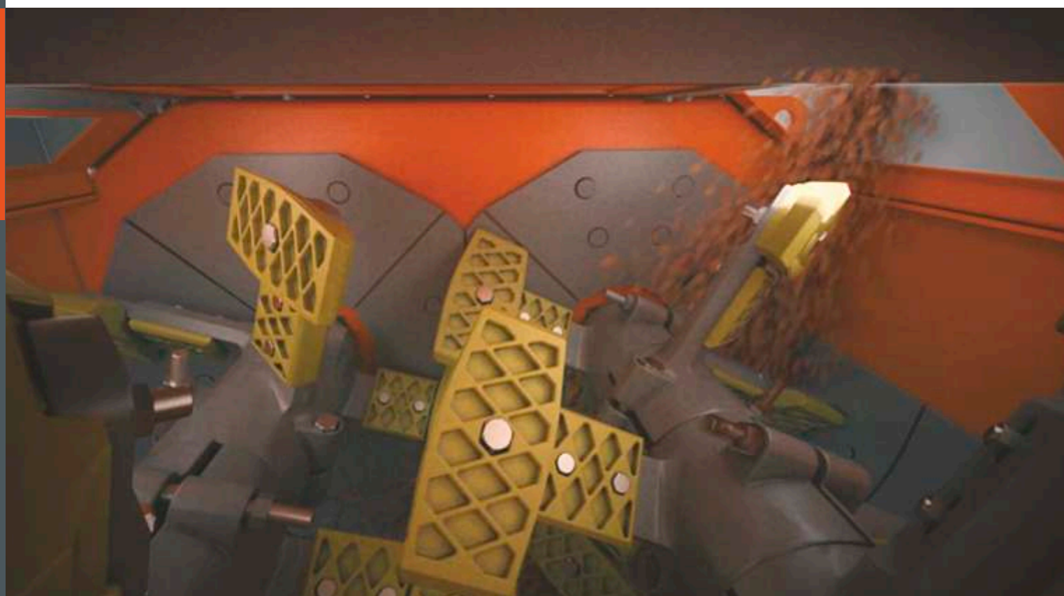
Malaxeur externe Pug-Mill avec zone de malaxage à sec.
